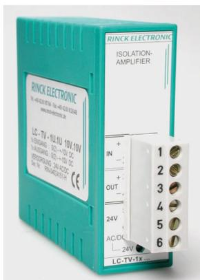
Trennverstärker sorgen für eine störungsfreie Übertragung von Signalen. Trennverstärker trennen Eingangssignale galvanisch von Ausgangssignalen. Sie trennen kleinere Signale von unterlegter Gleichspannung oder von niederfrequenten Wechselspannungen. Eine galvanische Trennung ist
